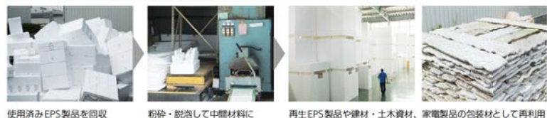
使用済みEPS製品を回収 粉砕・脱泡して中間材料に 再生EPS製品や建材・土木資材、家電製品の包装材料として再利用
